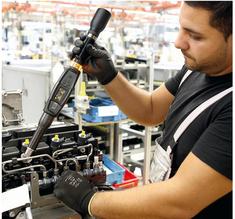
ziehen können und Sie zugleich die Möglichkeit der vollständigen Rückverfolgbarkeit erhalten. Der Drehmomentschlüssel ermöglicht sowohl die Qualitätskontrolle (Prüfung des Residualdrehmoments) als auch umfangreiche Schraubfallanalysen.
